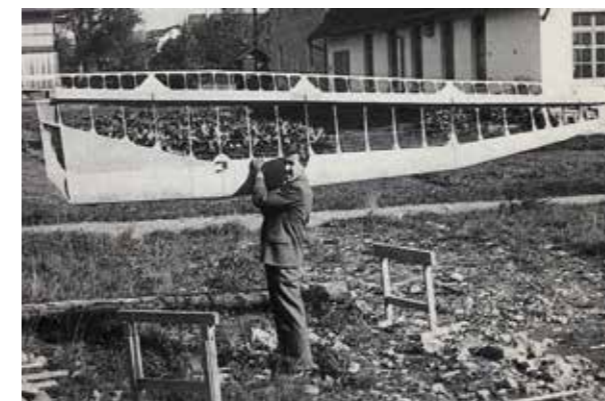
Sägi mit 9,6 kg leichtem Flügel
